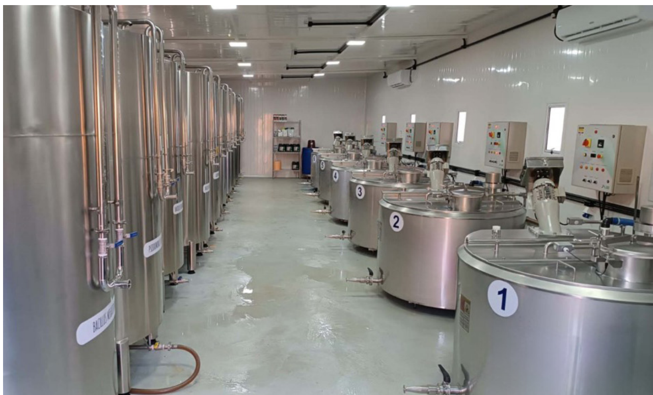
Figura 1 – Biofábrica para produção on-farm de microrganismos. À direita, biorreatores industriais destinados à multiplicação de fungos e bactérias em meio líquido; à esquerda, tanques para seu armazenamento.
