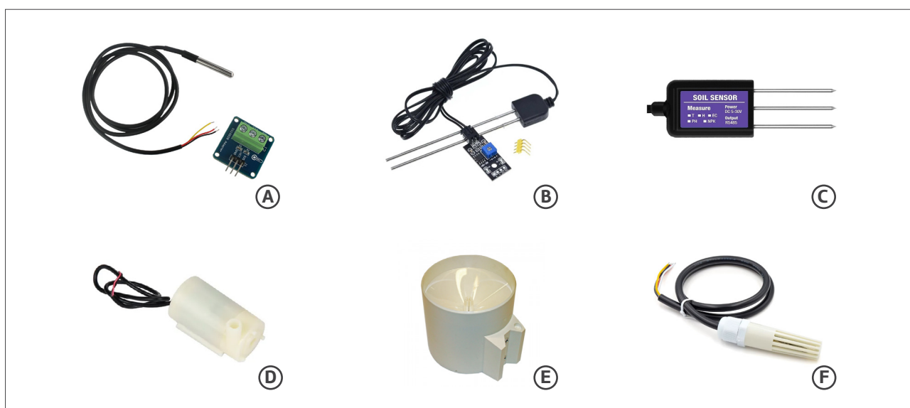
Figura 4 – Sensores meteorológicos: Temperatura de solo (A), Umidade do solo (B), NPK (C), Minibomba submersa (D), Pluviômetro digital (E), Temperatura e umidade do ar (F).
